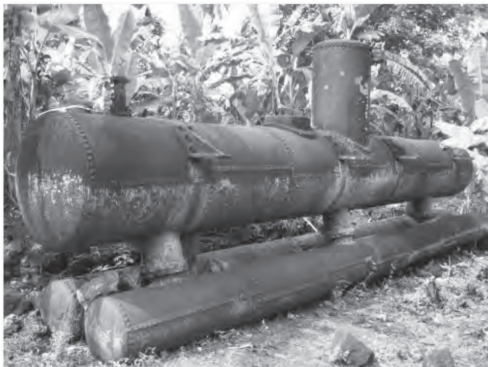
Chaudière à deux bouilleurs, Miréréni. © L. Lachery
